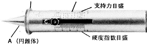
平坦に削った土壤断面に垂直にコーンを圧し込むとその際の抵抗に従ってバネが縮み、コーンは筒の内部に沈み、ツバは相対的に前進し、土壤断面を压しつけてコーンの動作を止めます。この機構に依って土壤の硬度は、コーンの穿入量、即ち土壤の歪みに必要な加圧力、即ちバネの縮長との二つの変化量の組合せに依って指示されます。但し [穿入部のコーンの高さ] + [バネの縮長] = 40mm の関係が常に保たれています。一般には簡単にバネの縮長目盛 (0 ~ 40mm) を硬度の指数として表示するのが実用的な慣例となっていますが、土壤の反力としての硬度はこの目盛の増加に対して別表の様に急激に増大する事は当然です。
